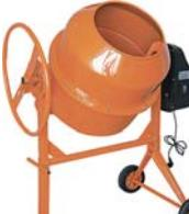
Бетоносмеситель гравитационный циклический. Предназначен для приготовления подвижных бетонных смесей с крупностью заполнителя до 40 мм и штукатурных растворов, применяемых в строительстве. Время перемешивания до 120 сек. Привод опрокидывания ручной. Напряжение питающей сети 220 В / 50 Гц. **79961** - пластиковый венец. **79962-79965** - чугунный венец.
