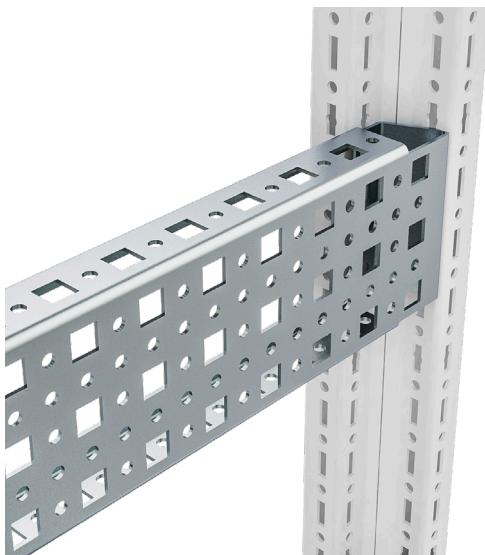
Планка ВМ монтажная тип К 23x73 предназначена для монтажа навесного оборудования при помощи резьбовыдавливающих винтов с шагом 12,5 мм, клетьевых гаек и винтов с шагом 25,0 мм. Планка навешивается на наружный монтажный уровень рамы RS52, крепится при помощи специальных комплектов крепления планок. Монтаж оборудования осуществляется на внутреннем монтажном уровне.
