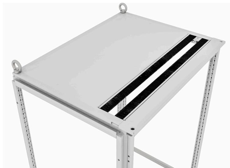
Панель потолочная с щеточным вводом двухсекционная RS52 устанавливается взамен серийной потолочной панели. Симметричная конструкция рамы RS52 может обеспечить ввод кабеля сбоку посредством поворота потолочной панели. Двухсекционное исполнение позволяет добавлять кабели после установки потолочной панели.
